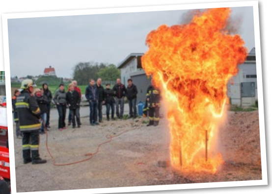
Oben: Explosion durch ein 1/8l Wasser in einem 1/2l heißem Öl.
